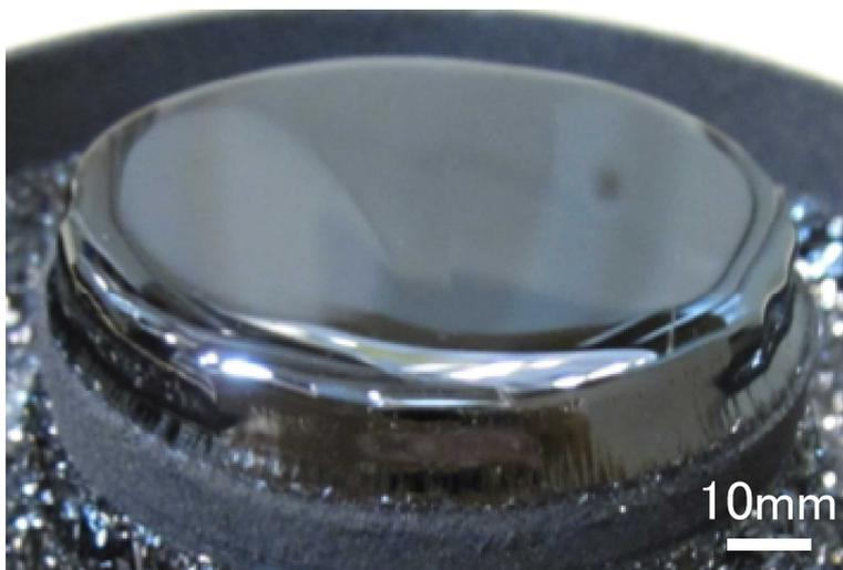
図 3 高速成長した高品質 n 型 SiC バルク単結晶
